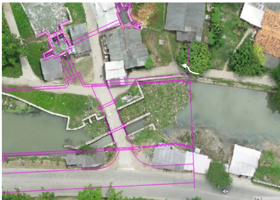
Gambar 9. Usulan pelurusan trase/alinyemen horizontal Bangunan Sadap B.TUB.23
