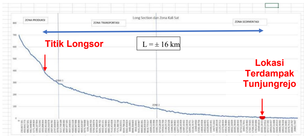
Gambar 7 Penampang memanjang Sungai Sat
