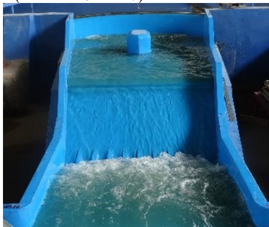
Gambar 16. Aliran Model Fisik Dengan Debit Kala Ulang 100 Tahun. ( 110 \text{ m}^3/\text{dt} )
