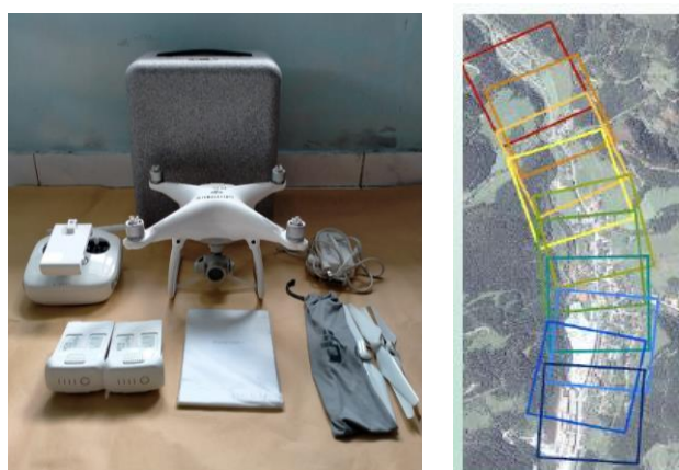
Gambar 2. UAV DJI Phantom 4 dan jalur penerbangan pemetaan udara
