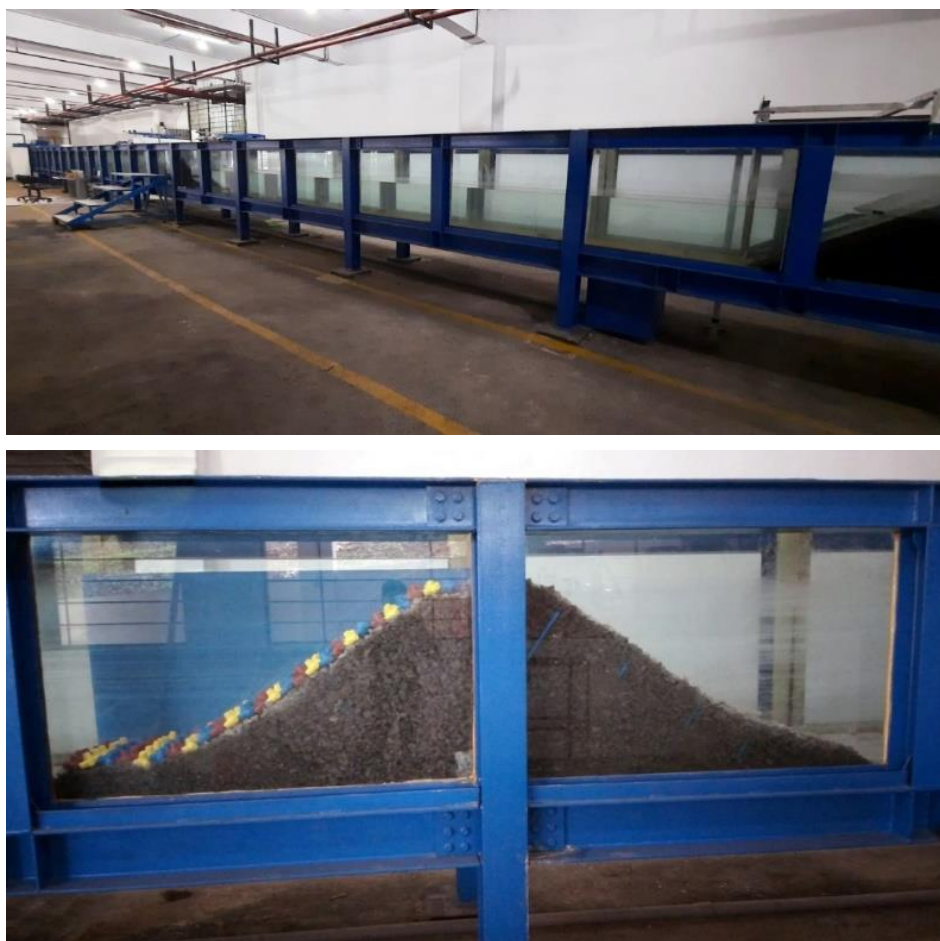
Gambar 7. Gambar penempatan model breakwater pada tangki gelombang.
