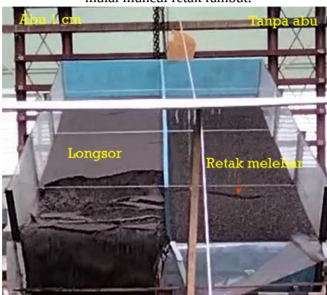
Gambar 4. Mekanisme longsor pada lereng demplot
