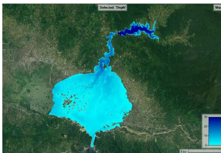
Gambar 9. Hasil simulasi genangan banjir akibat keruntuhan Bendungan Bulango Ulu skenario piping (profil – max depth)
