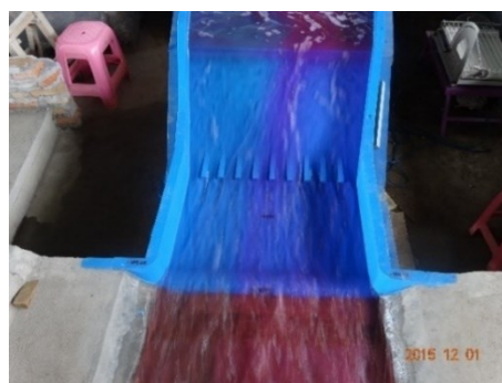
Gambar 13. Kolam Olak Tidak Berfungsi, Bila > Q 10 th
