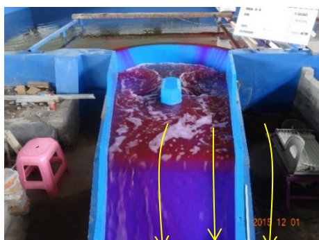
Gambar 12. Kolam Olak Berfungsi Maksimum Q 10 th
